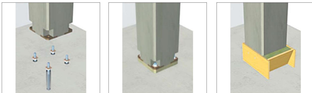
Pilt 4. Konstruktsioonelemendi monolitiseerimine
